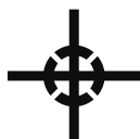
Abb. 1: Symbol für die Kennzeichnung des Schwerpunktes
