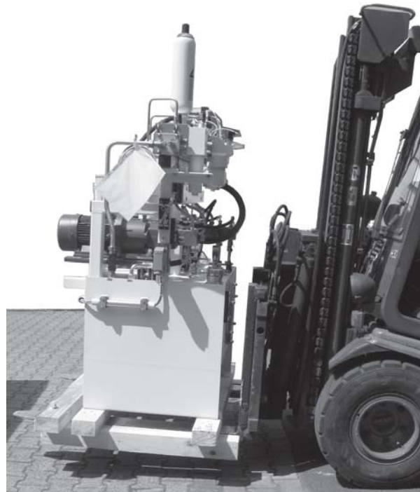
Abb. 4: Transport mit Gabelstapler
