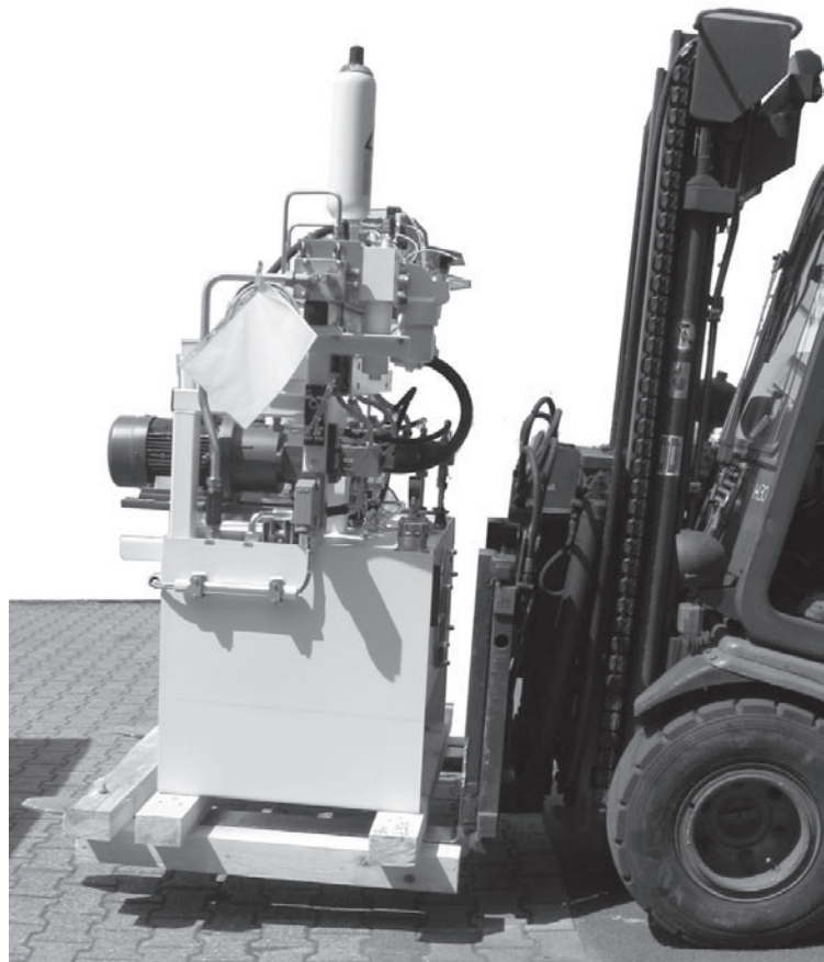
Abb. 4: Transport mit Gabelstapler
