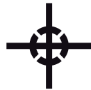
Abb. 1: Symbol für die Kennzeichnung des Schwerpunktes
