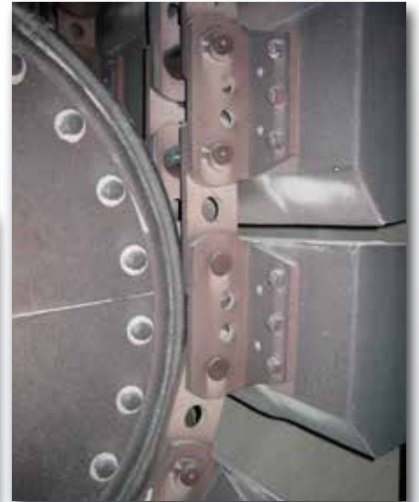
THIELE Optimierung einer Becherwerkskette – die Auswahl höherwertiger Werkstoffe, Wärmebehandlungen und Maschinenelemente verlängern die Wartungsintervalle.
